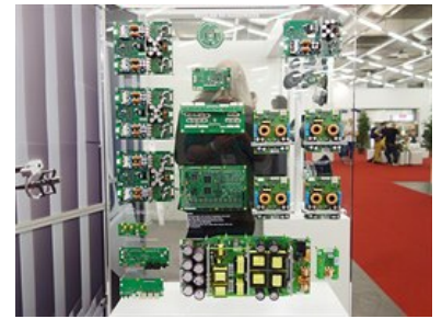
Elektronika BeoLab 90 pohromadě. Největší deska dole je napájecí zdroj, uprostřed deska se zvukovými procesory, kolem dokola pak výkonové zesilovače.
