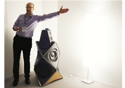
BeoLab 90 byly na výstavišti jen v temné poslechové místnosti, s komorním bočním nasvětlením. Tento snímek přidáváme jen pro srovnání velikosti s dospělým mužem. Reprosoustava má na výšku 1,27 m, váží 137 kg.
